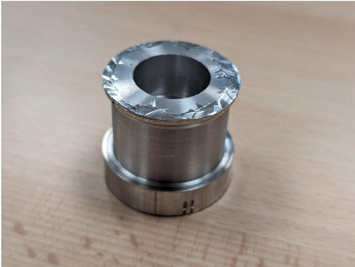
Comme l'on peut le constater sur la photo, nous pouvions réaliser la moitié de la pièce de façon non destructive. A partir de la seconde phase, à cause du manque de mors doux et d'une prise suffisante, notre prise a été très destructive sur la surface de prise.
